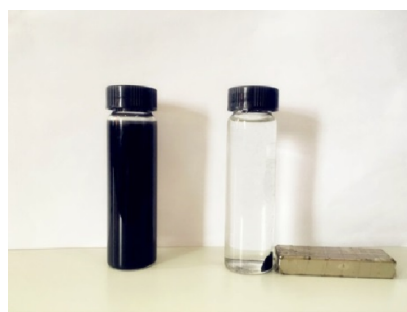
图 5 磁性生物炭的分离效果
