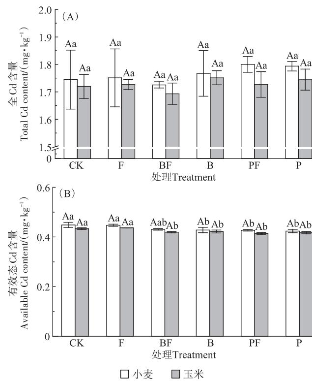
图 2 施加钝化剂及叶面肥对土壤全量 Cd 和有效态 Cd 含量的影响
