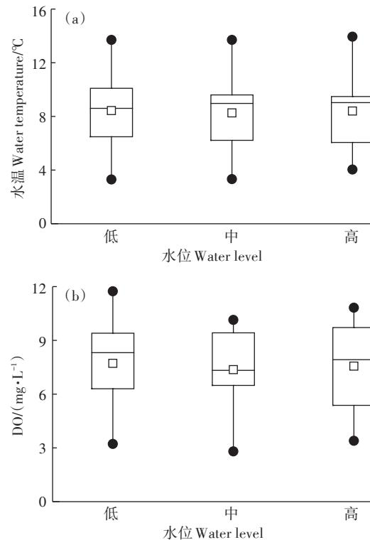
图2 绿狐尾藻生态沟渠低、中、高水位下水温和DO
