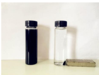
图 5 磁性生物炭的分离效果
