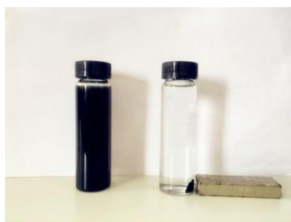
图 5 磁性生物炭的分离效果
